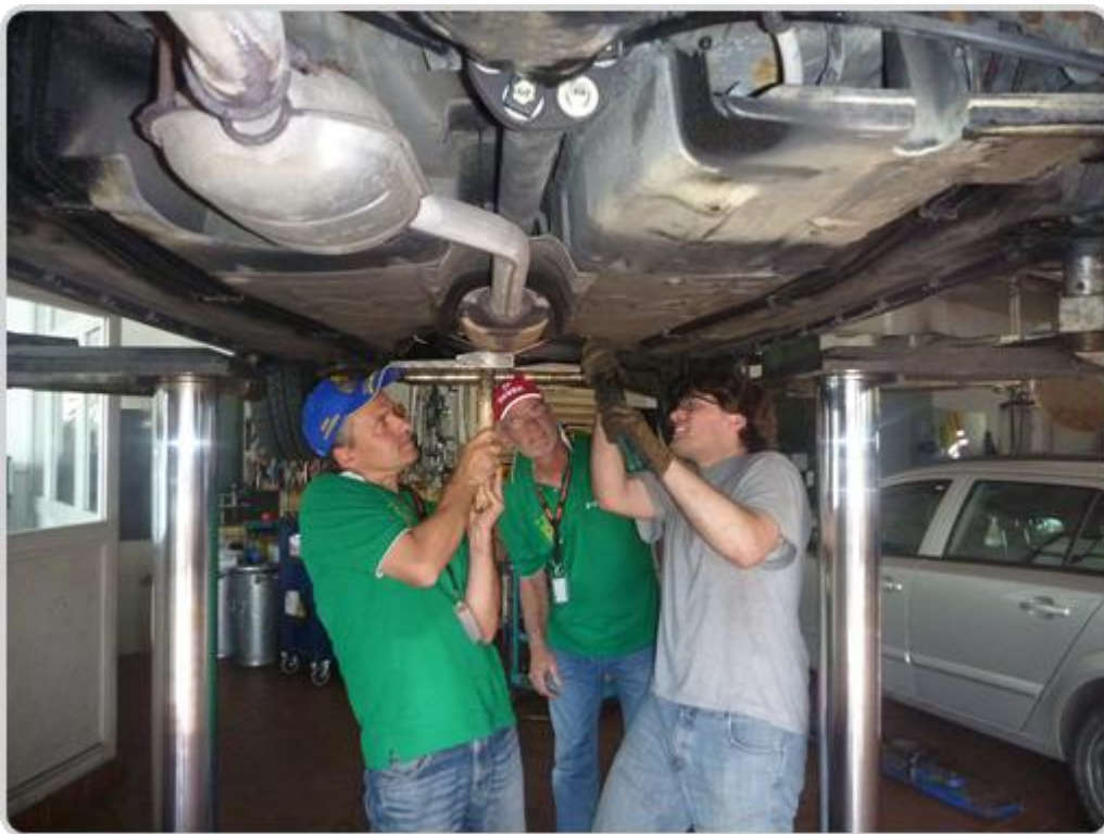
Nur so kann ein Auspuff repariert werden. Mit Schweißdraht und Hammer.
